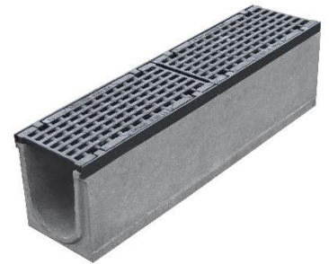
Langsgående lamelrist i støbejern Indløbsareal 736 cm 2 /m Slidsbredde 12 mm
