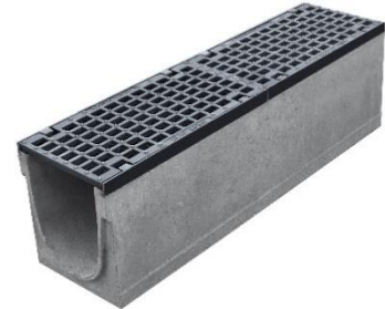
Maskerist i støbejern Indløbsareal 1.040 cm 2 /m Slidsbredde 30/20 mm
