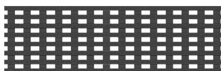
Komposit rist m. langsgående lameller Indløbsareal 360 cm 2 /m
